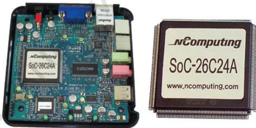
O System-on-Chip (SoC) da NComputing está no núcleo de cada dispositivo de acesso
